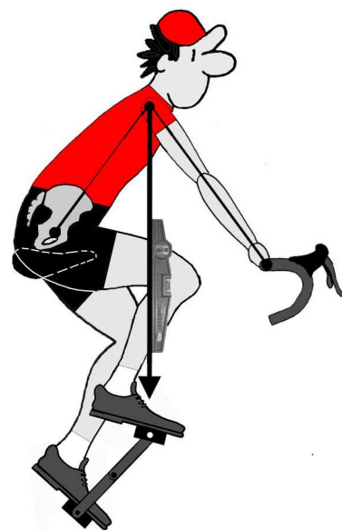
Figure 15.33. Une méthode pour approcher la bonne hauteur du cintre.
