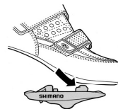
Figures 15.9, 15.10, 15.11 et 15.12. Les pédales automatiques. Enclenchement de la cale et dégageement du pied sur le modèle A520 de Shimano. Ce modèle utilise des petites cales qui permettent la marche sur certaines chaussures.
