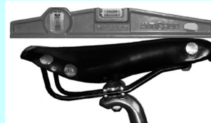
Figure 15.28. Inclinaison de la selle de Maurice.
